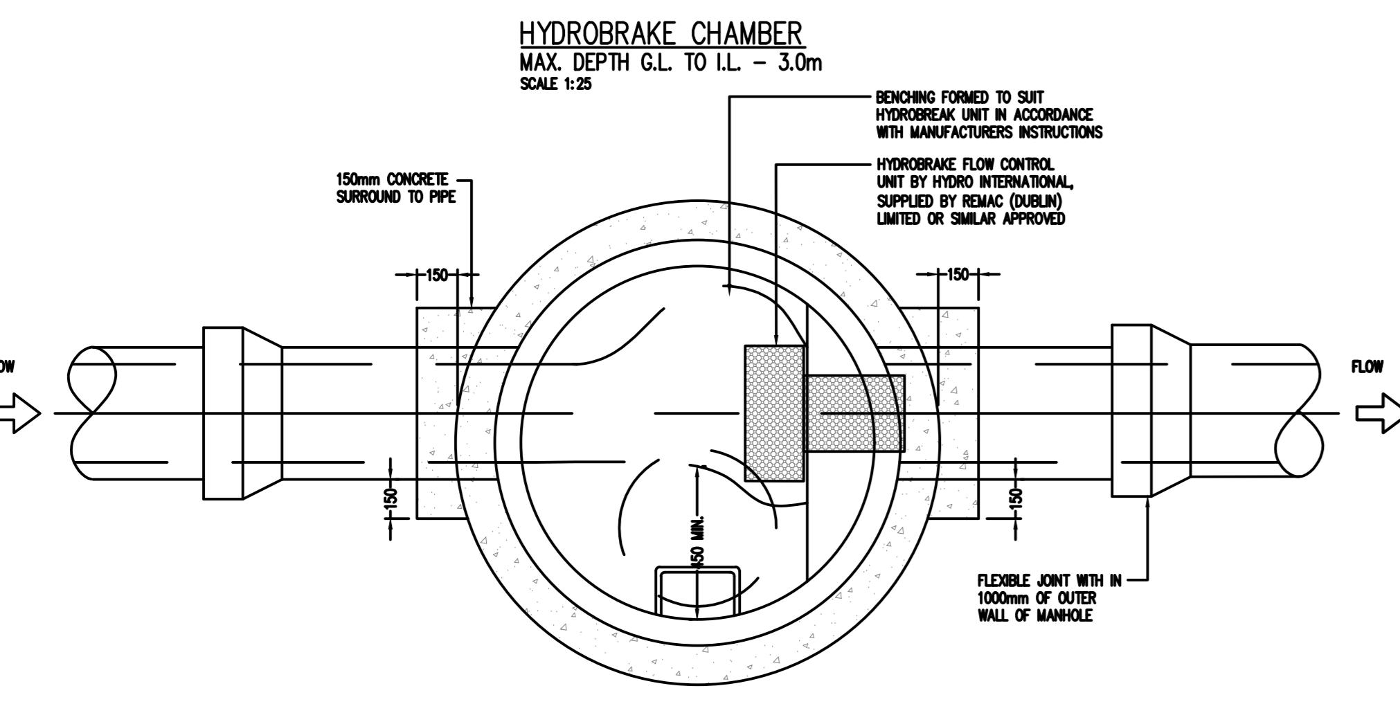
PLAN ON HYDROBRAKE CHAMBER
